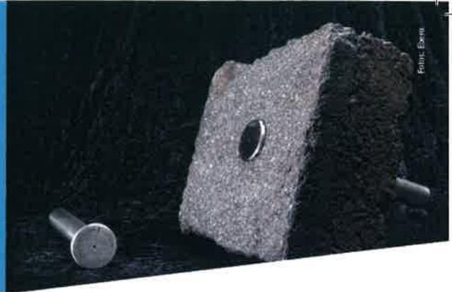
Mit der Gasdiffusionshülse können Suchgeräte austretendes Gas über die Radialnut und dank einer kleinen Bohrung im Deckel schnell identifizieren. Die Montage ist denkbar einfach: Loch bohren, Hülse einschlagen, fertig! Eine Sache von zehn Minuten. Aufwändiger Straßenbau ist überflüssig.
